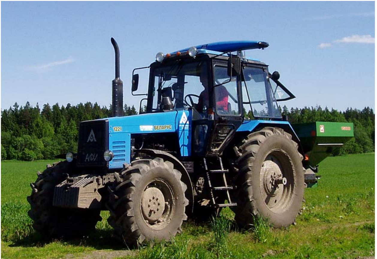
Рис.7. Трактор МТЗ 1221 с установленным распределителем минеральных удобрений Amazone ZA-M 1500 novis и Hydro N Sensor.
