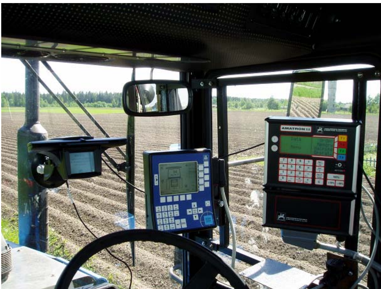
Рис.9. Бортовые компьютеры Amatron II А и Hydro, а также контролер курса в кабине трактора
