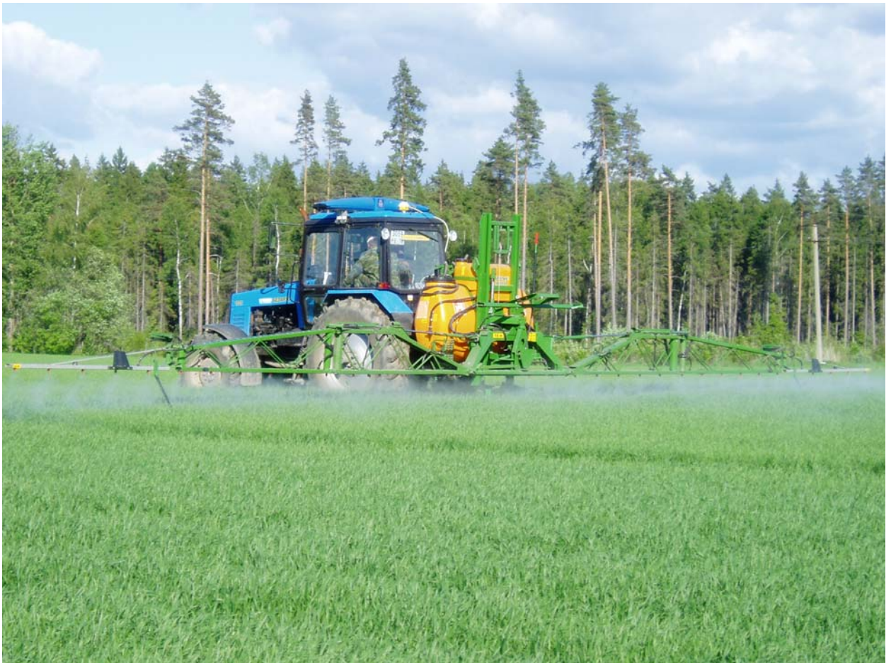
Рис 8. Навесной опрыскиватель Amazone UF 800
